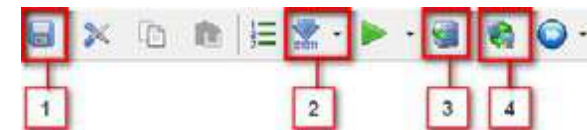
Рисунок В.10 – Панель конфигурирования ПЛК. 1- Сохранить проект, 2 - построить конфигурацию для верхнего уровня, 3 – загрузка конфигурации в ПЛК, 4 – запуск глобального опроса (всех устройств)
